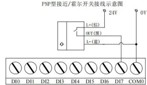
上图：PNP 接近 / 霍尔开关为常开型 (NO)，模块用此接法 (COM 端共阴极) 为常开输入；反之，若 PNP 接近开关为常闭型 (NC)，模块用此接法为常闭输入。
