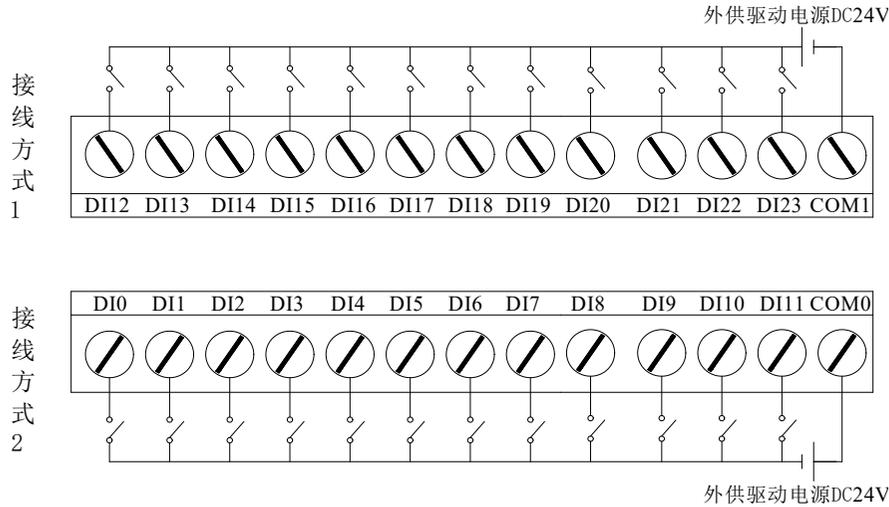
输入方式：支持 NPN 或 PNP 型输入，外部供电 24VDC；
