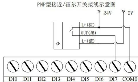
上图：PNP 接近 / 霍尔开关为常开型 (NO)，模块用此接法 (COM 端共阳极) 为常闭输入；反之，若 PNP 接近开关为常闭型 (NC)，模块用此接法为常开输入。
