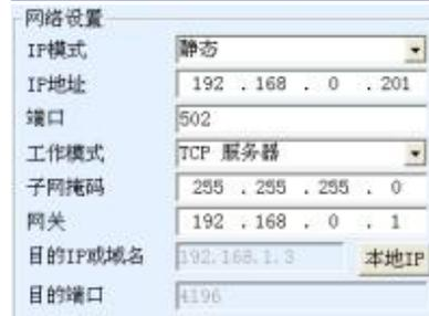
网络设置可根据现场实际情况设置 IP 地址、子网掩码、网关；工作模式是 TCP 服务器；端口固定在 502 端口。
