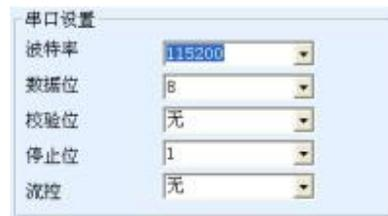
串口设置：此波特率必须与此产品的 12 位薄码开关的 8、9、10 对应的波特率一致；数据位、校验位、停止位、流控只支持 8 位数据位、无校验、1 位停止位、无流控，不能改成其它参数；
